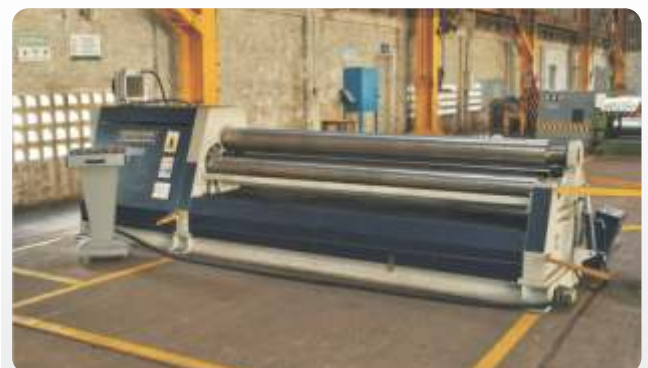
CALANDRA CIP4-3008 Calandragem de 3 mm a 2 ½" por 2,5 metros de comprimento
