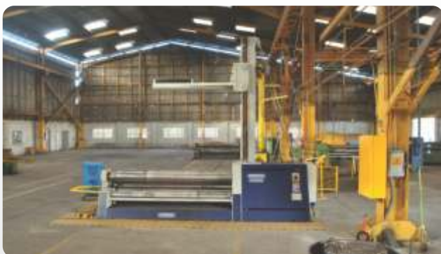
CALANDRA CIP4-2525 Calandragem de 3 mm a 2 ½" por 2,5 metros de comprimento
